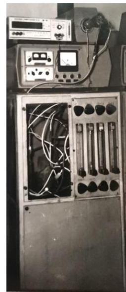
Рис.1. а) Схема установки выращивания НК Si из газовой фазы и распределение температуры в реакционной зоне: 1, 6—8, 12—18 — вентили, 2—5 — ротаметры, 9—11 — барбатеры; б) Внешний вид экспериментальной установки
