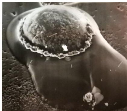
Рис. 2. Движение капли расплава по поверхности монокристаллической пластины кремния под действием продольного градиента температуры
